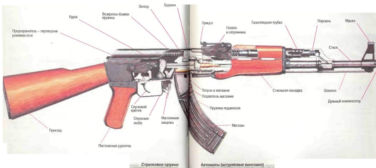
Рисунок 1 – Автомат АК-47 с обозначением деталей
